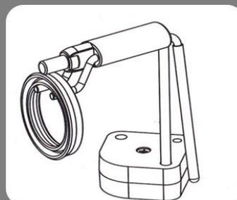
Appoggiare la guarnizione come da immagine e ruotare il braccetto dell'utensile a 360°
